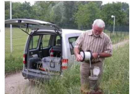
Messung mit einem Lichtlot an einer Grundwassermessstelle
